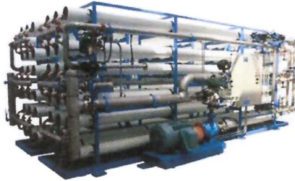
Generalmente se colocan de 2 a 6 membranas por módulo y pueden utilizarse más de una etapa para lograr una mayor conversión. A continuación se muestra un esquema de una posible configuración de osmosis inversa.
