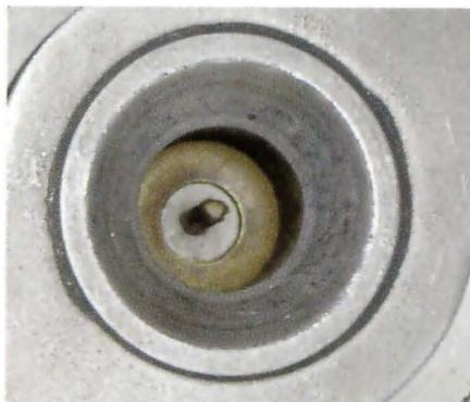
Pecíolo de una hoja en la tapa de una Bomba de Scholander. Cuando la presión en la cámara es equivalente a la tensión de la savia, la savia aparece por el pecíolo.
