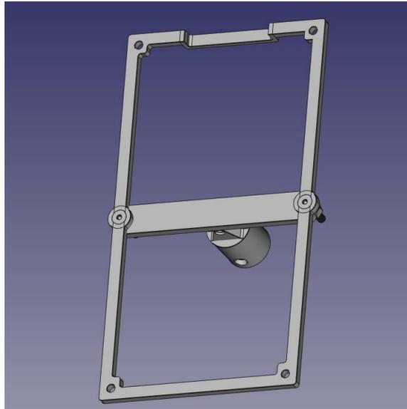
Figura 12. Diseño de soporte para panel solar.
