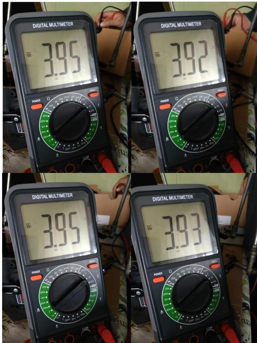
Figura 6. Nivel de voltaje en las baterías de 4 nodos luego de 12[h] de funcionamiento.
