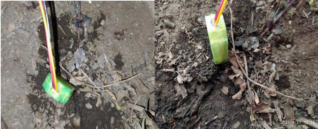
Figura 19. Sensor de tipo capacitivo seleccionado para medir la humedad.
