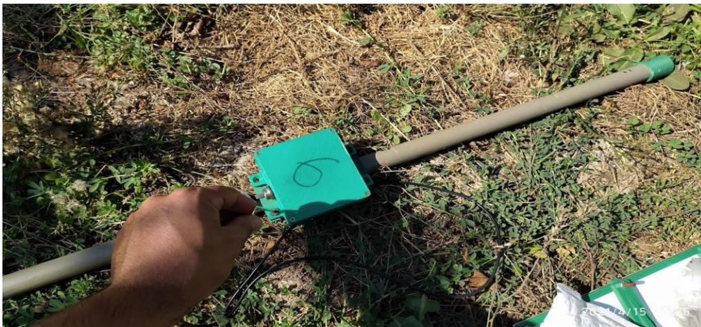
Figura 17. Poste con nodo sensor instalado.
