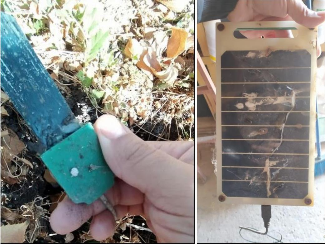
Figura 37. Sensor de humedad y panel solar.
