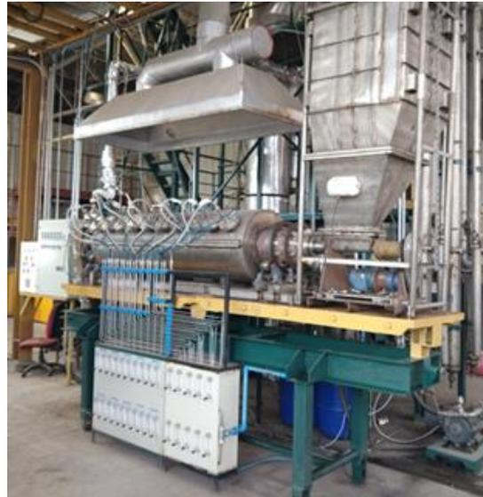
Figura 2: Planta piloto de pirólisis UDT
