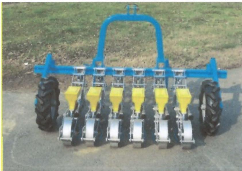
Figura 53. Sembradora Bassi SP 2002 de 6 unidades para montar en tractor de baja potencia.
