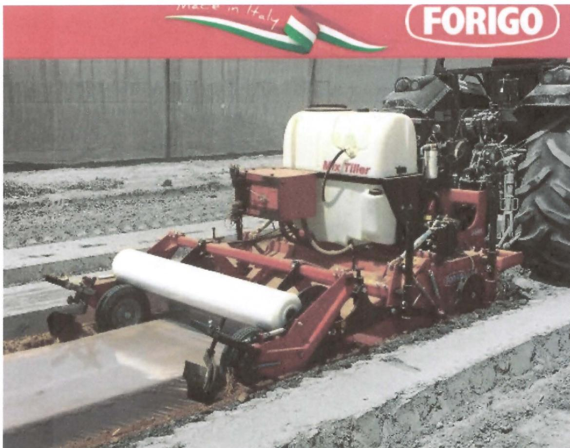
Figura 32. Máquina desinfectadora de suelo.
