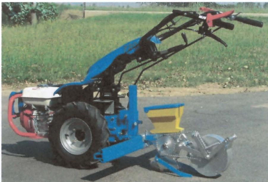
Figura 51. Unidad de siembra adaptada a un motocultor.
