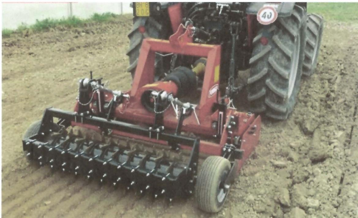
Figura 11. Modelo para tractor de baja potencia.
