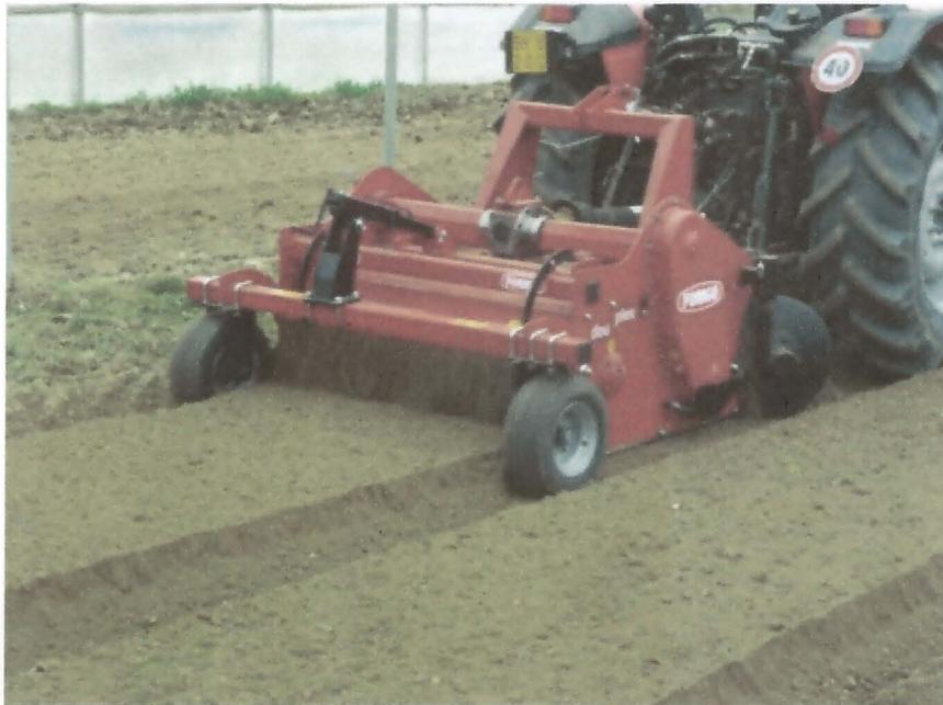
Figura 23. Conformadora de mesas para tractor de baja potencia.
