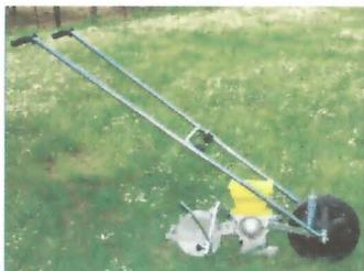
La rueda trasera es de PVC de alta resistencia, un material sobre el que la tierra se pega con mayor dificultad, y está provisto de rodamientos de bolas herméticos para una gran duración en el tiempo.
