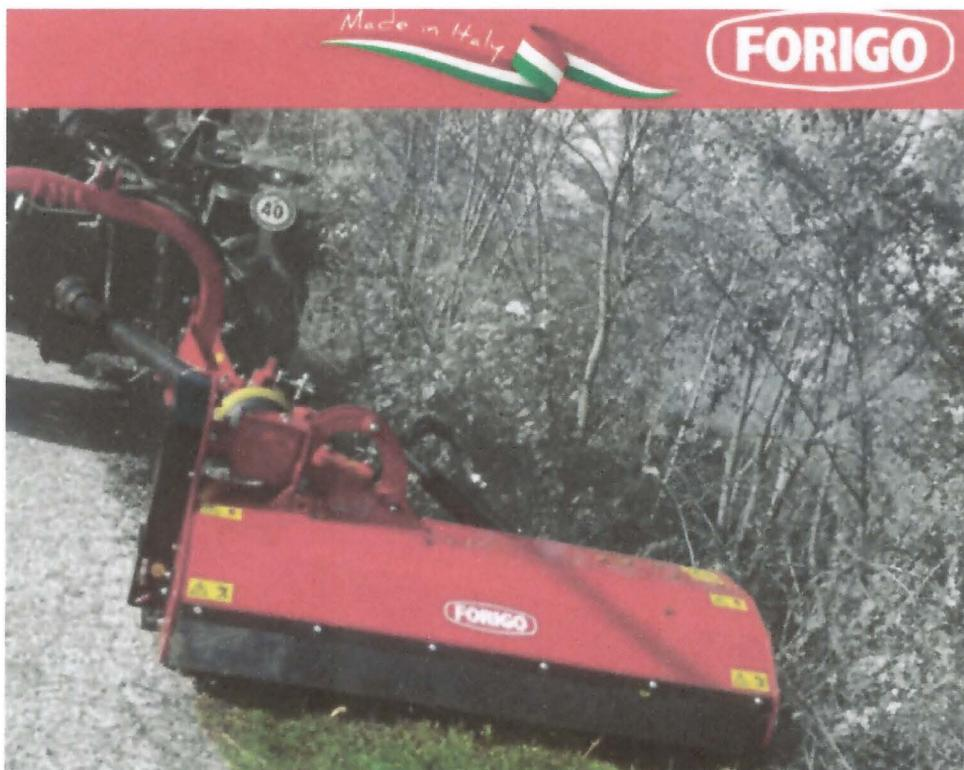
Figura 16. Trituradora de rastrojo de accionamiento lateral al tractor.
