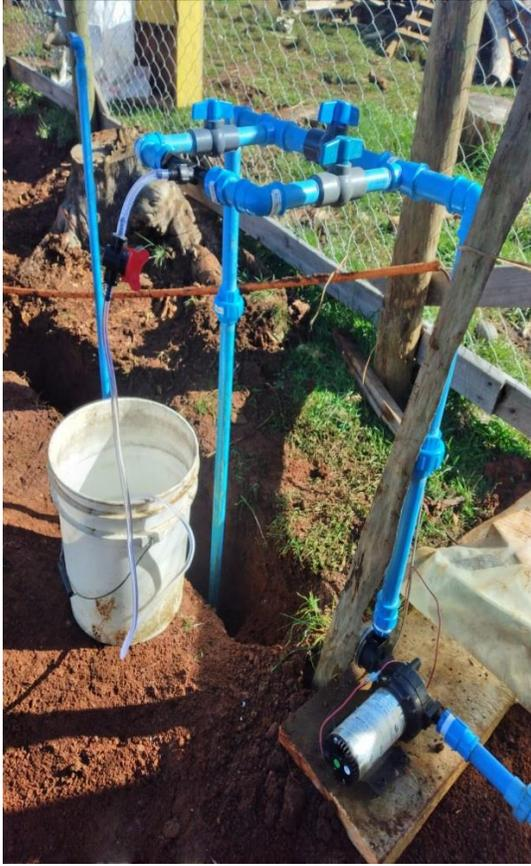
**Foto 6. Sistema venturi, para aplicación de tees orgánicos mediante el riego.**
