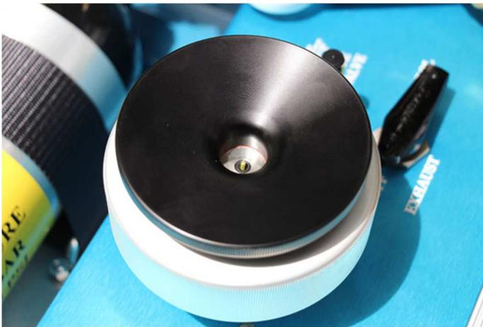
Presione la tapa hacia abajo y gírela hasta la posición de bloqueo.
