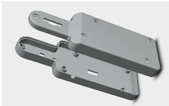
Figura 1.3.- Primer diseño de carcasa para el sensor
