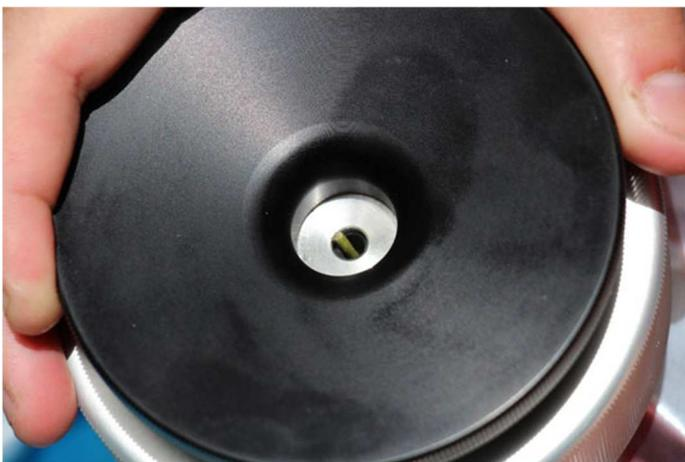
Apriete el pecíolo en su lugar girando el "Anillo o válvula" negro en el sentido de las agujas del reloj y apretando la junta hacia abajo en el pecíolo.
