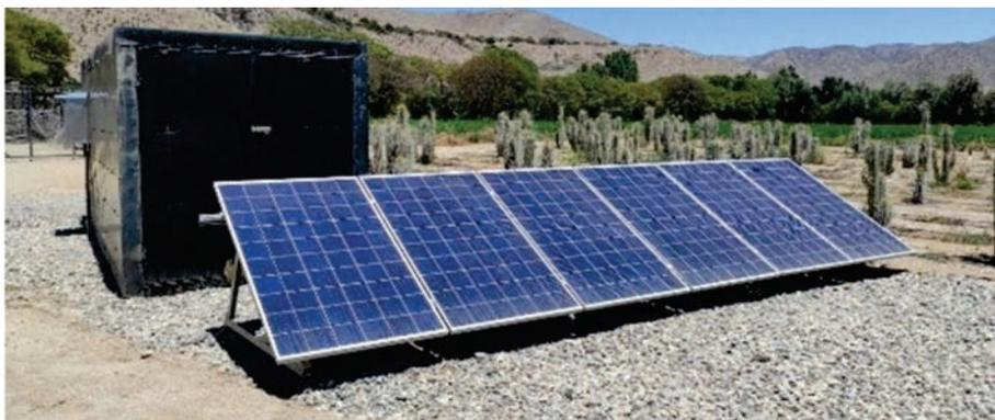
**Figura 10.** Container deshidratador solar instalado con sistema fotovoltaico complementario.
