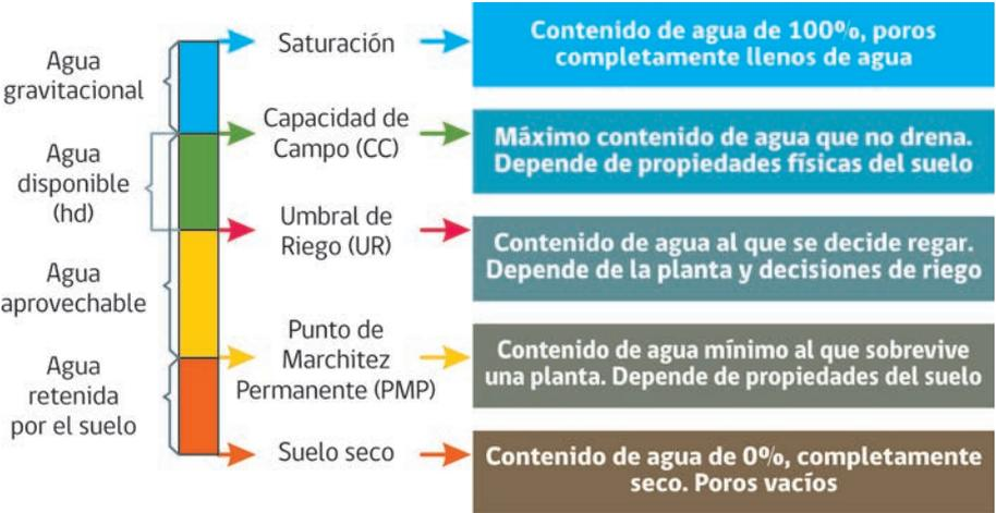
**Figura 6.** Esquema de niveles de contenido de agua en el suelo.
