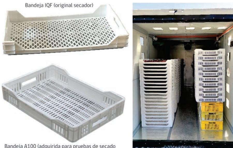
**Figura 15.** Tipos de bandeja probadas en el secado en sistema CDS.
