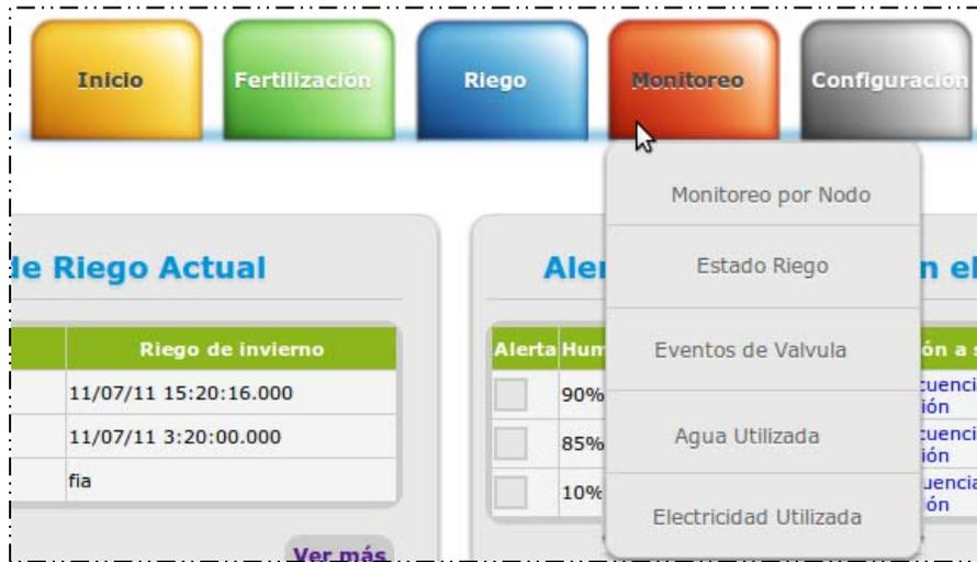
En este módulo podrá acceder a monitorear el huerto por nodo, a ver el estado del riego, a ver los eventos de las válvulas y a ver el agua y la electricidad utilizadas en el huerto.
