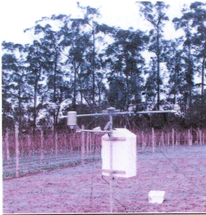
Foto 2.- Estación meteorológica Delta-T instalada en la localidad de Cañete
