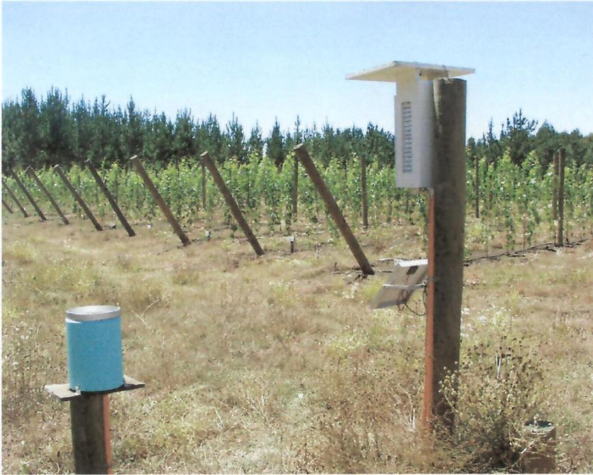
Foto 3. Estación meteorológica automática instalada en Chanco.
