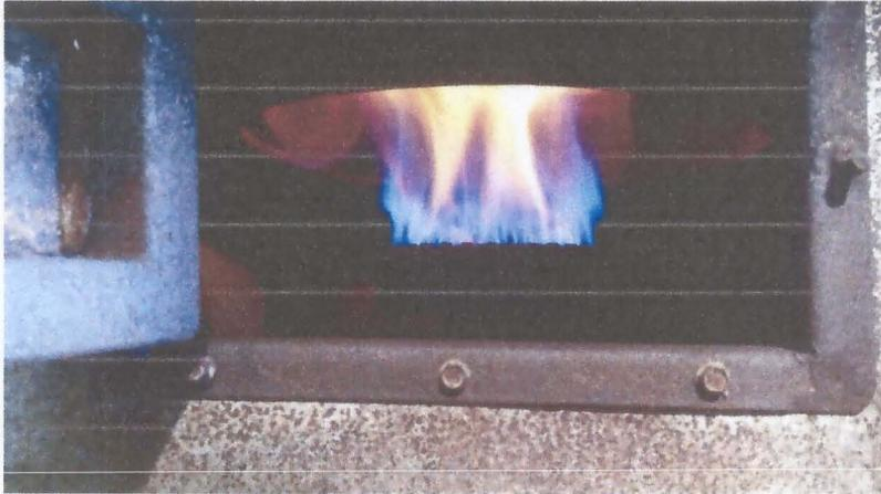
**Figura 22: Quemador a Biogás en Caldera 200 litros. Fuente: Biotecsur**
