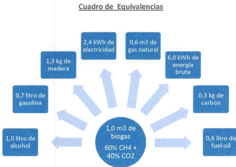
**Figura 10: Equivalencias de biogás con otras fuentes de energía - Fuente: Guía de planificación para proyectos de biogás en Chile, Junio de 2012.**
