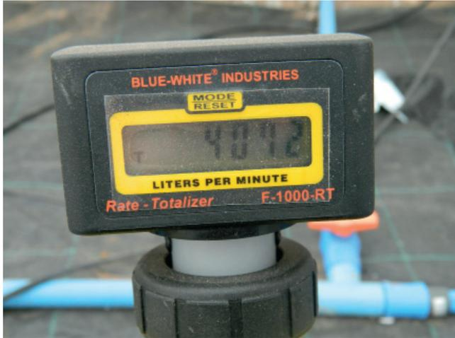
Figura 23. Medidor de caudal en línea del volumen de agua.
