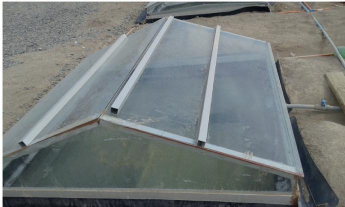
Figura 12. Destilador solar pasivo de 2 m<sup>2</sup>. Pozo Almonte
