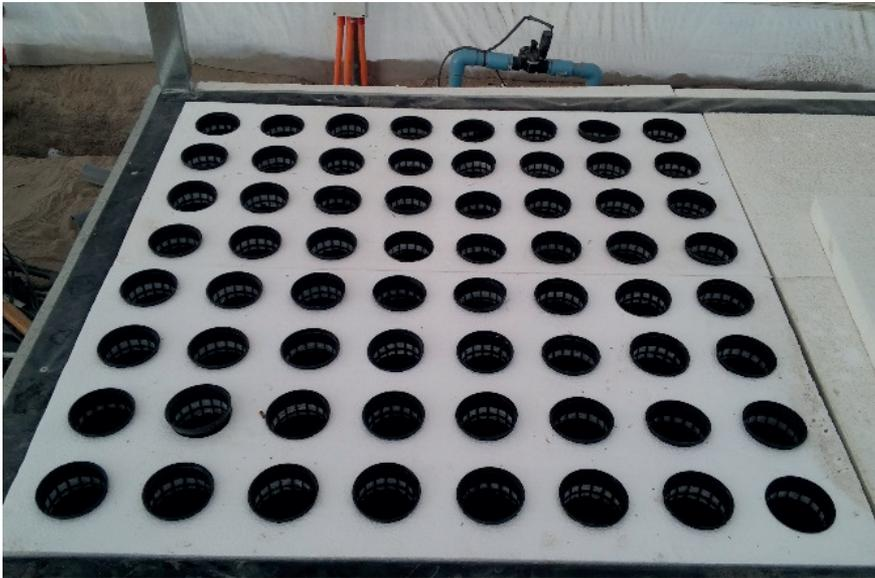
Figura 21. Sección de una unidad aeropónica con plancha de poliestireno de 50 mm de espesor y con canastillos hidropónicos incorporados.
