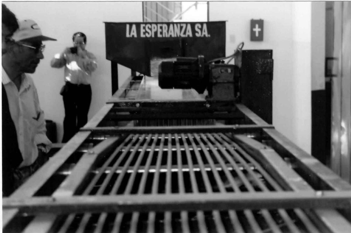
Foto 17 Máquina descarozadora
