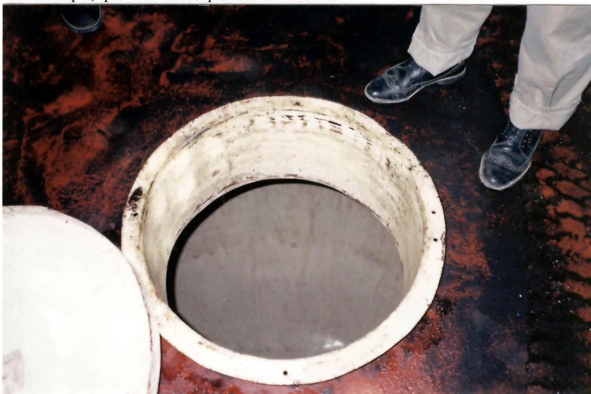
Foto 7 Las aceitunas son extraídas desde estanques enterrados a tolvas inclinadas, a través de bombas de vacío.
