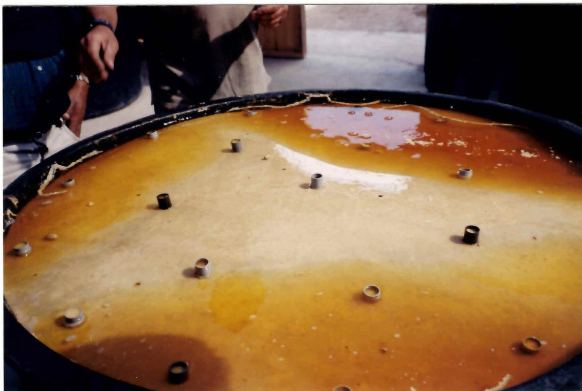
Vista de la entre tapa de los pindongos, fabricada en fibra de vidrio, utilizada para impedir que las aceitunas floten y queden en contacto directo con el aire.
