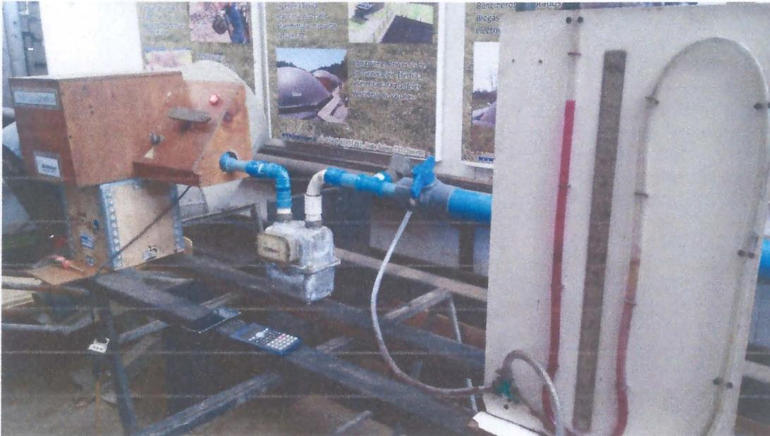
En la fotografía se observa a la izquierda el Soplador, al centro el Contador volumétrico, a la derecha el manómetro de columna de agua.
