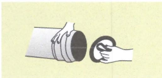
Existen 2 tipos de unión: **unión cementar** que se utiliza para diámetros entre 20 y 50 mm, y **unión con anillo de goma o unión Anger** para diámetros entre 63 y 400 mm.
