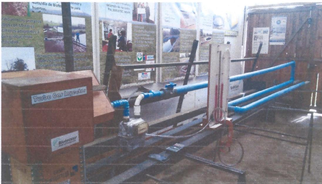
En la fotografía se observa el sistema de pruebas con Tubería de 63mm de diámetro instalada posterior al contador volumétrico.
