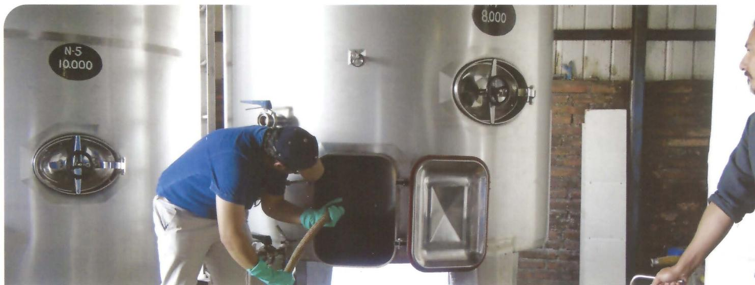
cada cierto tiempo deben ser sanitizados. Los equipos de molienda, mangueras, bombas, tanques de fermentación, al igual que utensilios usados para fermentar, drenar y recibir vino, deben estar **siempre limpios y sanitizados**, destinando espacios exclusivos para la guarda de estos materiales que entran en contacto con el vino.
