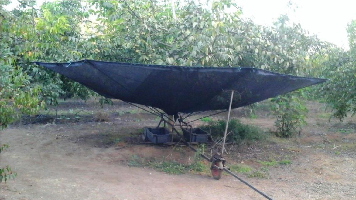
Se fabrico prototipo de capturador, base y varillas de despliegue metálicas, y pantalla capturadora de en malla , en la fabricación de este prototipo no se incluye motor, cinta transportadora ni soplador.
